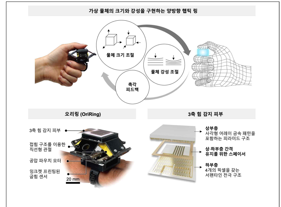
그림 1. 햅틱 오리링(OriRing)의 양방향 피드백 및 오리링(OriRing)과 3축 힘 센서(Three-axis force-sensing skin)의 구조도
